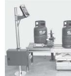
**Машина для проверки ориентации вентиля VOS**
