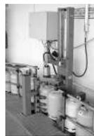
**Оборудование для маркировки баллонов СУГ**
